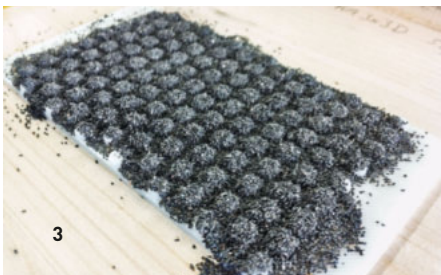
3 3D-Prüfkörper mit Korund-Abstreuerung/ 4 Abstreubild durch gezieltes Applikationsverfahren/ 5 Mit Lochblechen abgestreute Asphaltoberfläche kurz nach dem Einbau/ 6 GripTester
